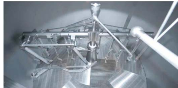
Bild 2: Läuterbottich mit Hackwerk
