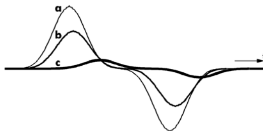
Abbildung 19: Auswirkung der Integrationszeit auf das Messsignal
