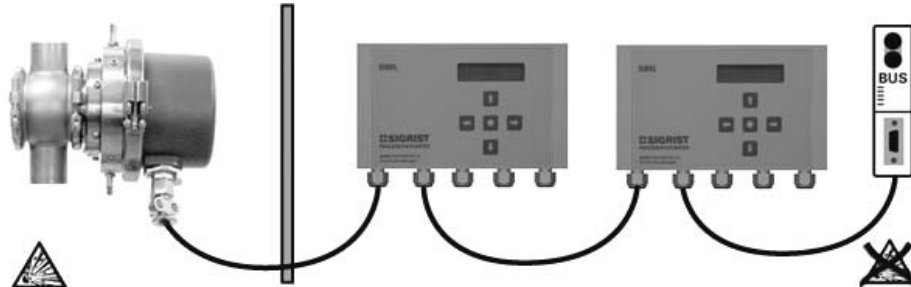
Abbildungen 15+ 16: Betrieb mit zwei Bedienungsgeräten und Buskoppler.
